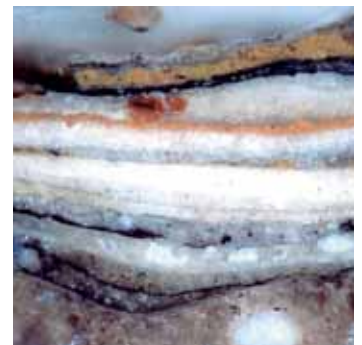
▲ Abb. 13 Querschliff QS 4141b; 75-fache Vergrößerung des Gefachputzes (Aufnahme: Prof. Dr. H.-P. Schramm).
