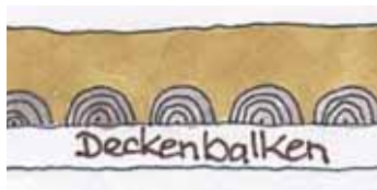
▲ Abb. 8 Schematische Skizze des Bodenaufbaues im Querschnitt (bräunliche Schicht = Estrich).
