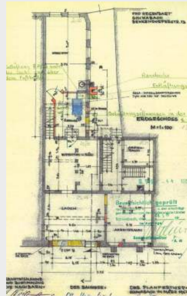
Abb. 3 Die vergleichsweise harmlose Planung von 1965 sah im Erdgeschoss des Hauptbaus die Schließung (mit Backstein, rot angelegt) der in der Längswand mittig stehenden, ursprünglich wegen der Befundlage (auf die nachfolgend noch eingegangen wird) sicherlich renaissancezeitlichen Türöffnung zu Raum 0.9 vor. Außerdem erweiterte man die beiden Vorgängerfenster zu einem großformatigen Schaufenster.
