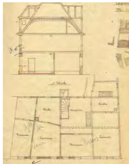
▲ Das überlieferte Schema der Grundrisse im Obergeschoss hat sich bei diesem Umbau dagegen fast unverändert erhalten (Pläne: Archiv Stadtbauamt Schwabach).
